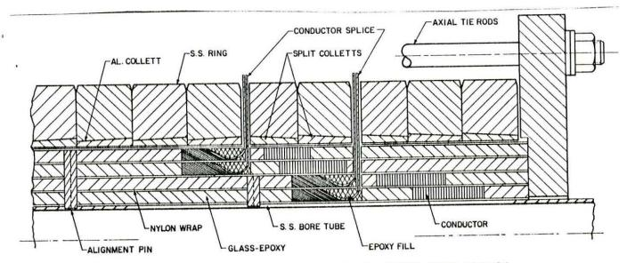
LONGITUDINAL CROSS SECTION OF 4 LAYER DIPOLE D-9A
