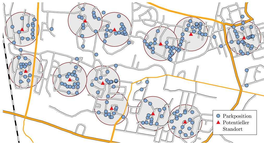
Abbildung 9.2: Standortkatalog via Partial Set Covering (Skizze) (95% Abdeckung, 12 potentielle Standorte)
