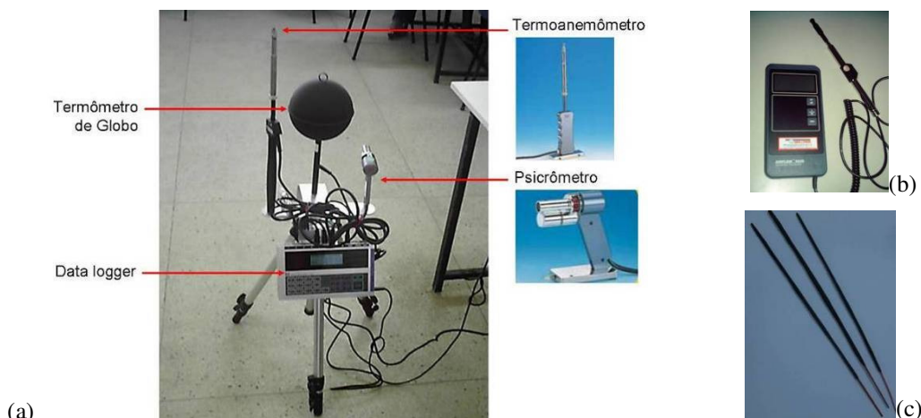
Figura 4 – Equipamentos de medição utilizados para o monitoramento: (a) Confortímetro Babuc A, (b) Termoanemômetro de fio quente portátil Airflow Developments, modelo TA-35 e (c) Sticks de fumaça utilizados para visualizar o fluxo de ar.
