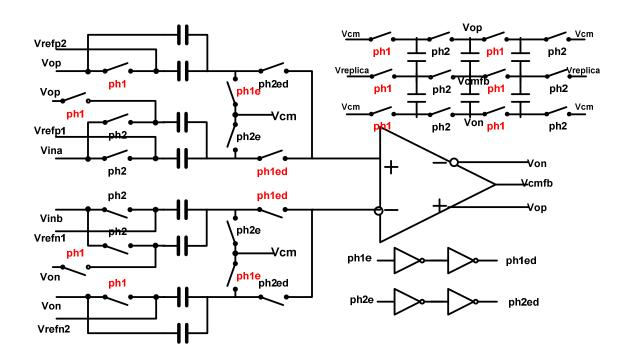
Figure 5.6 1<sup>st</sup> 2<sup>nd</sup> 3<sup>rd</sup> MDAC.
