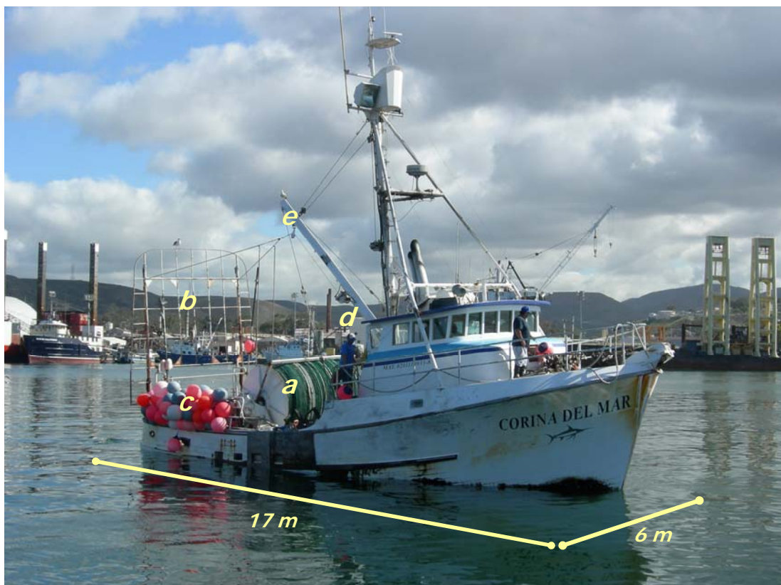
Figura 6. B/M Corina del Mar , embarcación típica que utiliza como arte de pesca la red agallera de deriva, dimensiones y sus principales características: a) carrete, b) raca, c) flotadores, d) winche y e) pluma.
