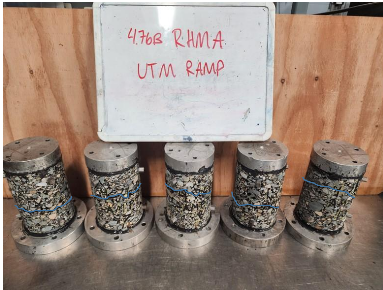
a) RHMA-G tensile ramp failures
