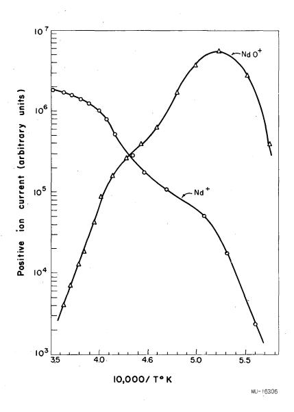
Fig. 20. Ionization of neodymium on tungsten.
