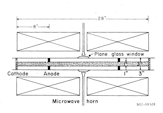
Fig. 21. PIG discharge apparatus.
