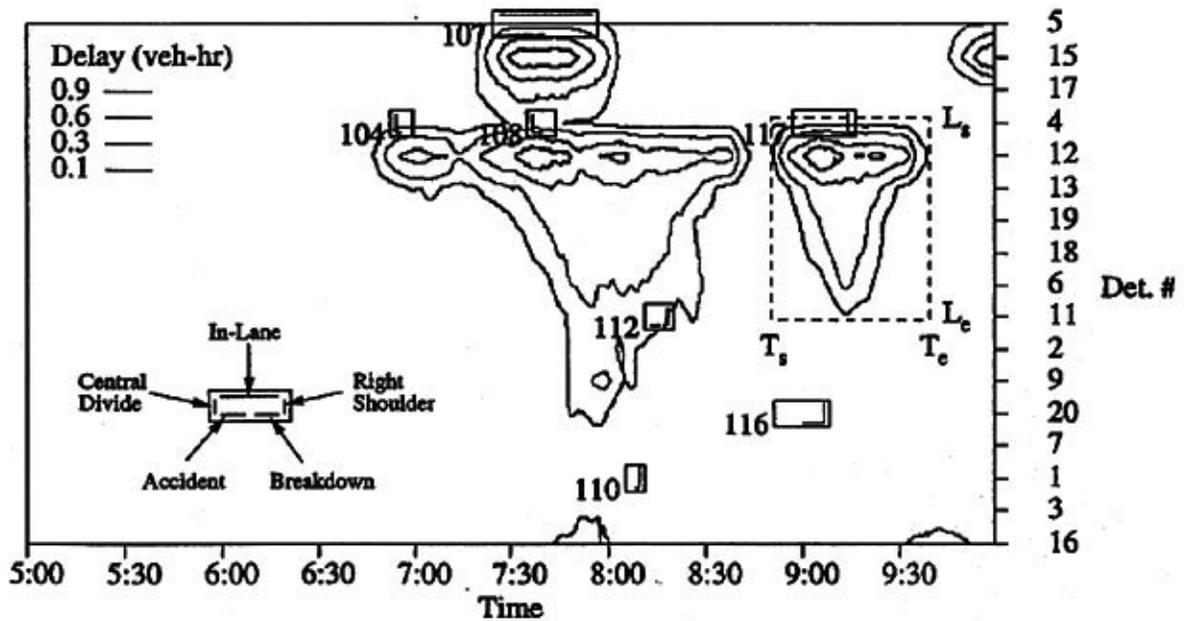
FIGURE 5.3 INCIDENT DELAY ESTIMATION FROM LOOP DETECTORS
