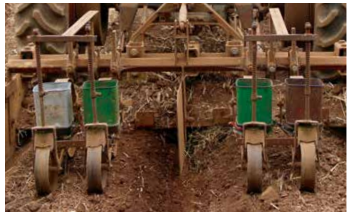
FIGURA 3. Sembradora tipo Planet Jr. montada al tractor (arriba) y sembradora manual (abajo) utilizada para cultivos de siembra directa. Fotos: Martha Brown
