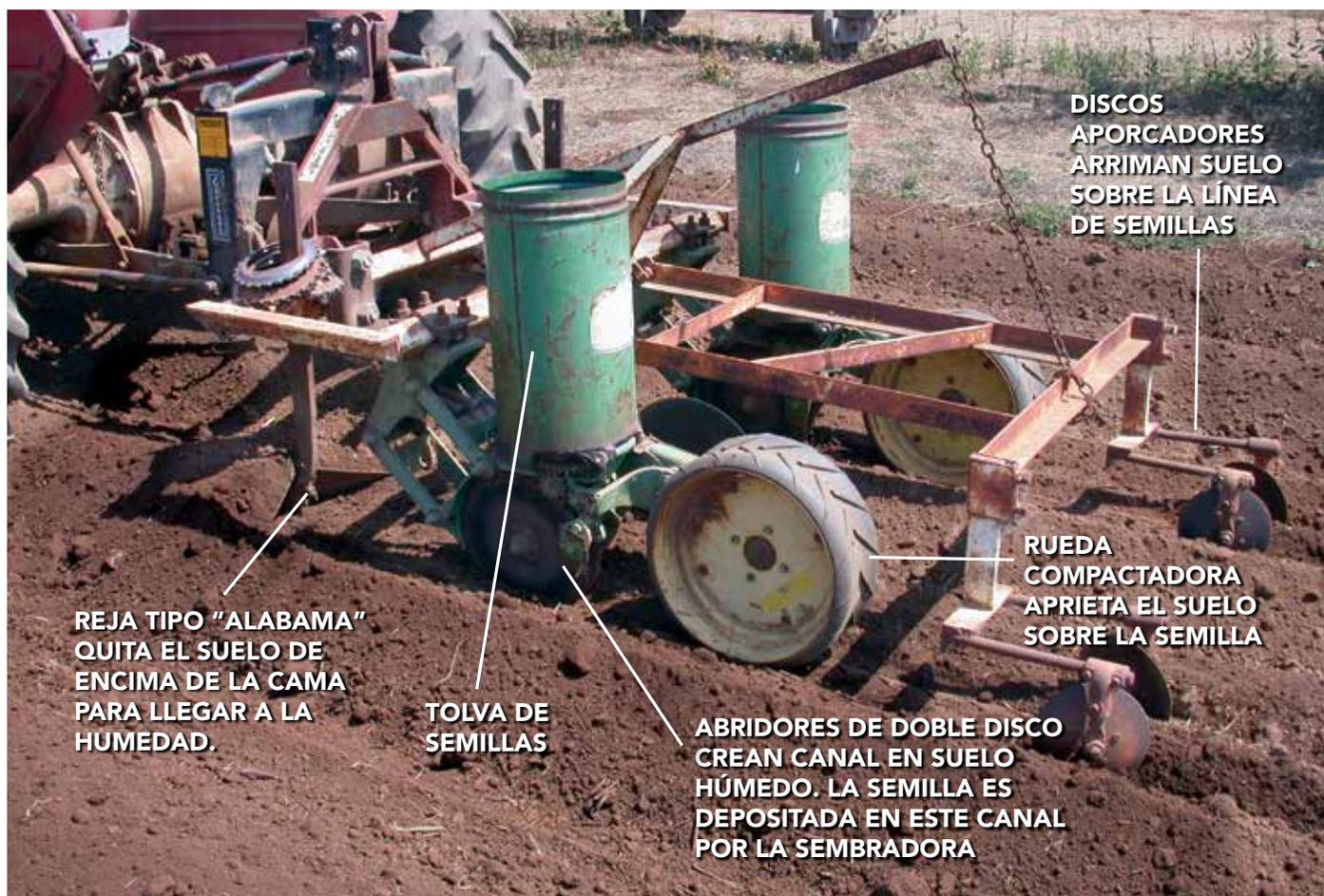
FIGURA 2. Una sembradora "flexi" John Deere 71 ajustada para la siembra directa de frijol. Foto: Jim Leap
