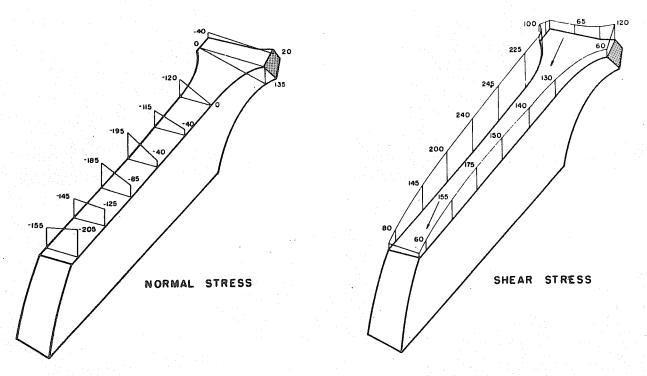
B - HYDROSTATIC LOAD
