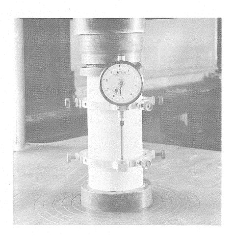
FIGURE 44 - LIGHTWEIGHT ALUMINUM COMPRESSOMETER FOR 3- BY 4-INCH PLASTER CYLINDERS
