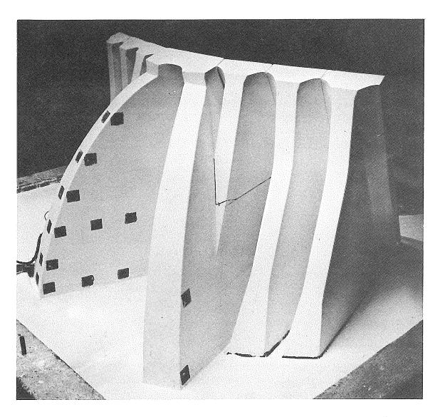
FIGURE 8 - THE COMPLETE MODEL BEING FITTED WITH STRAIN GAGES
