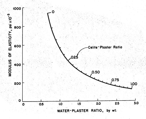
FIGURE 50 - VARIATION OF ELASTICITY WITH WATER-PLASTER AND CELITE-PLASTER RATIOS FOR PLASTER OF CONSTANT CONSISTENCY
