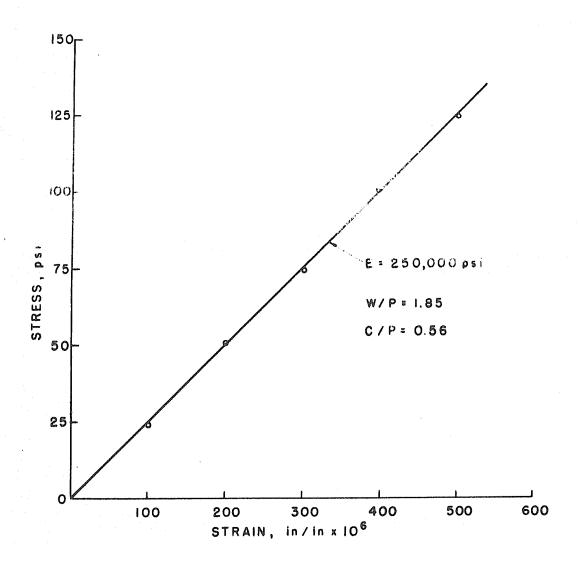
FIGURE 45 - TYPICAL STRESS-STRAIN DIAGRAM FOR PLASTER
