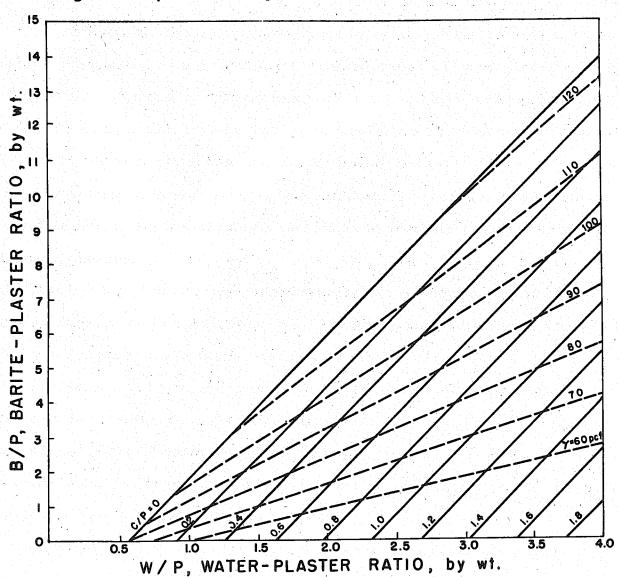
FIGURE 66 - DESIGN CHART FOR HEAVY PLASTER MIXTURES
