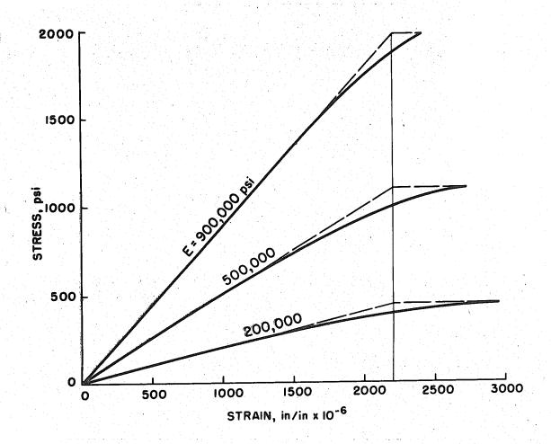
FIGURE 54 - COMPLETE STRESS-STRAIN DIAGRAMS SHOWING CONSTANT LIMITING STRAIN FOR A VARIETY OF PLASTERS
