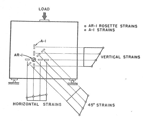
FIGURE 17 - TEST FOR ACTION OF STRAIN GAGE ROSETTES
