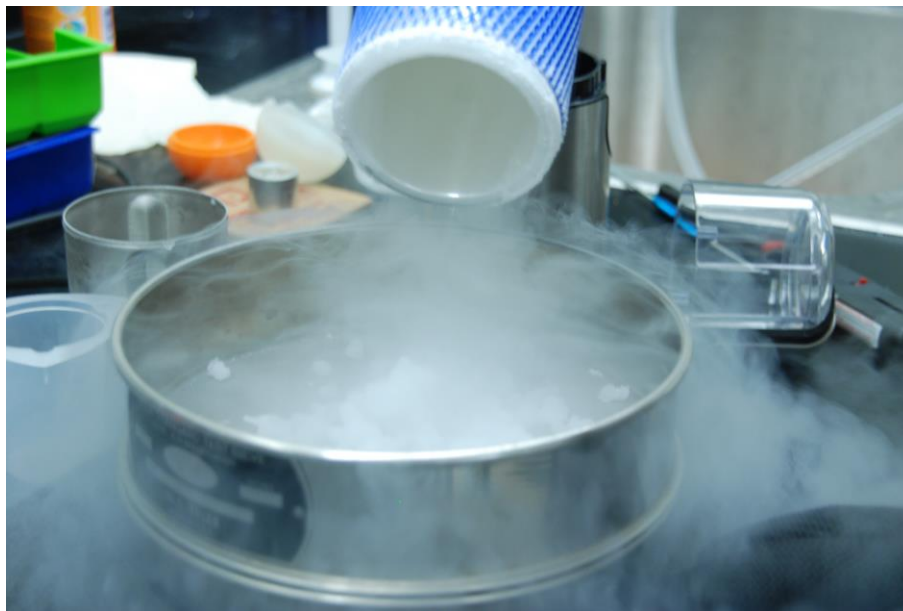
Figure 14. Pour liquid nitrogen onto the mesh.
