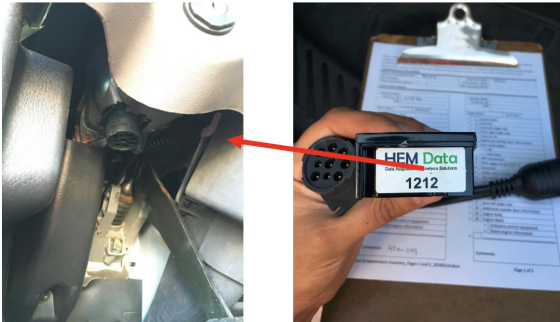
Figure 29. J1939 Mini Logger™ used for data collection
