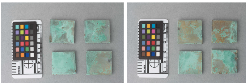
(d) P2 coupons after 24 hour immersion in 150 ppm Propolis 2 solution
