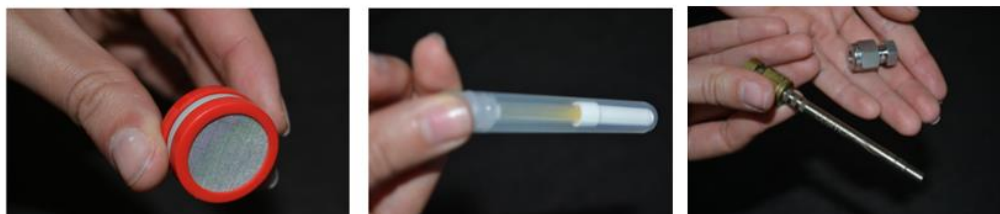
Obr. 5 Vzorok slúžiaci na odber koncentrácie NO 2 (vľavo), formaldehydu (v strede) a prchavých organických látok (vpravo)
