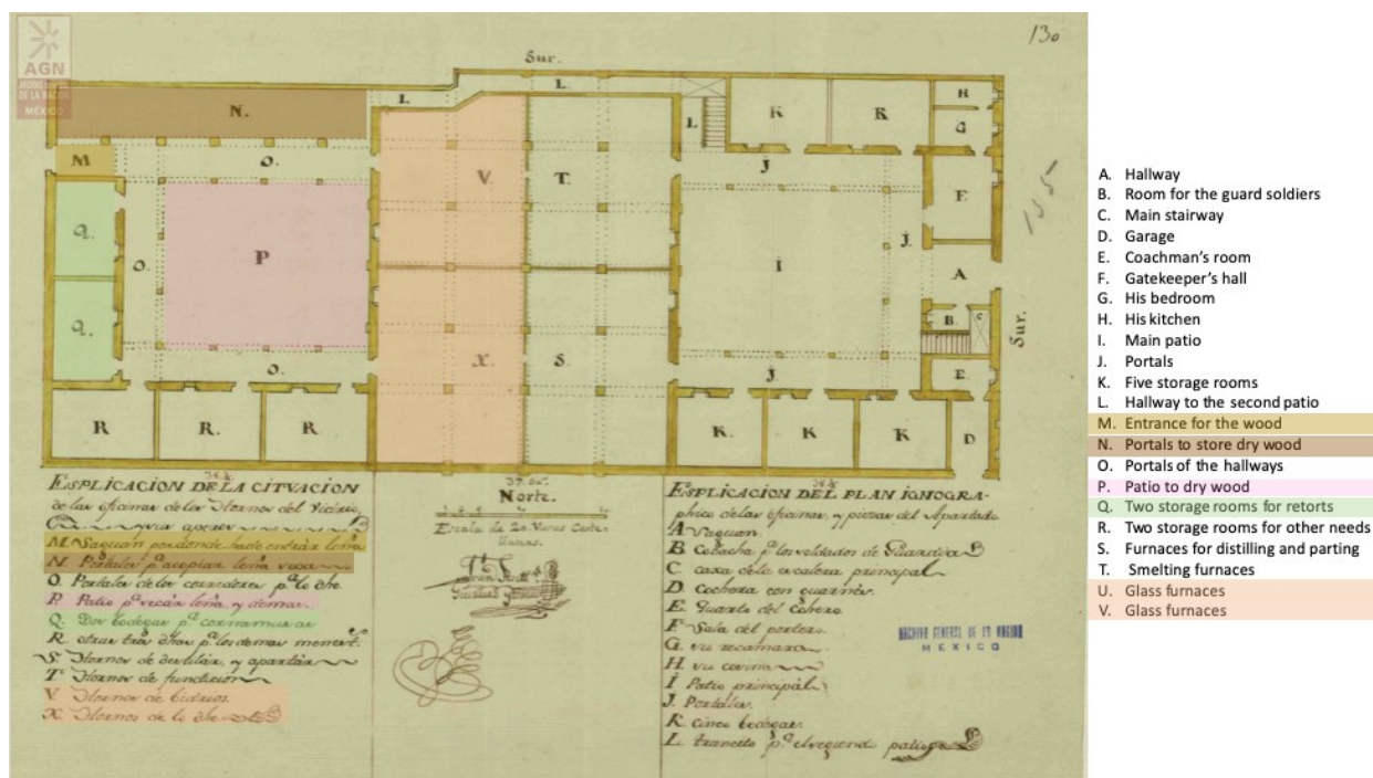
Figure 57. Plan of the workshops in the Casa del Apartado. (modified from Francisco Antonio Guerrero y Torres, Explicación de las oficinas de los hornos de vidrio , 1779; AGN, Mapas, planos e ilustraciones, no. 139; AGN, Correspondencia de Virreyes, 1ª serie, vol. 116, exp. 4, f. 155v).
